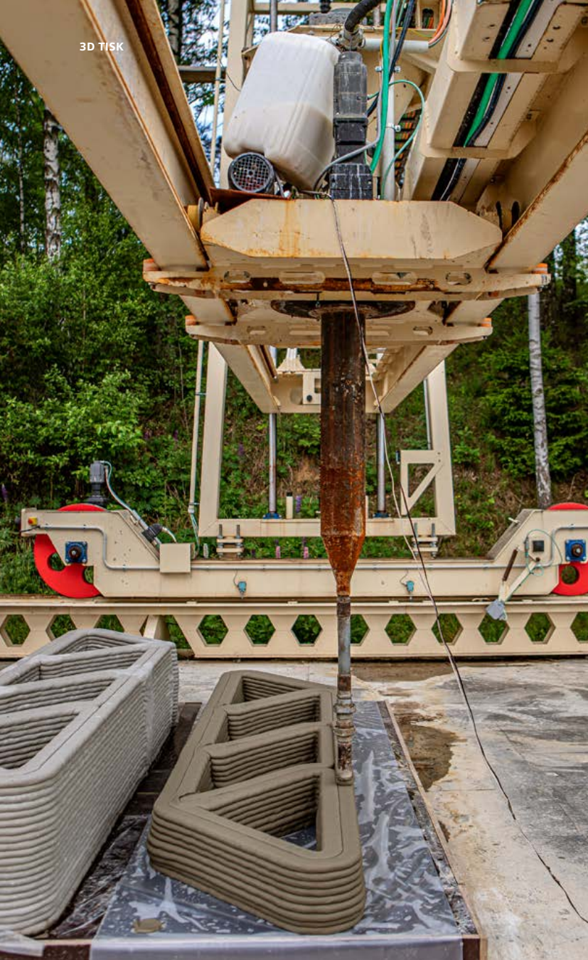
3D tiskárna betonu vyvinutá za spolupráce firem Podzimek & synové a Strojírny Podzimek, Ústavem konstruování a částí strojů Fakulty strojní ČVUT a Fakulty stavební ČVUT (zdroj: www.podzimek3d.cz ).
